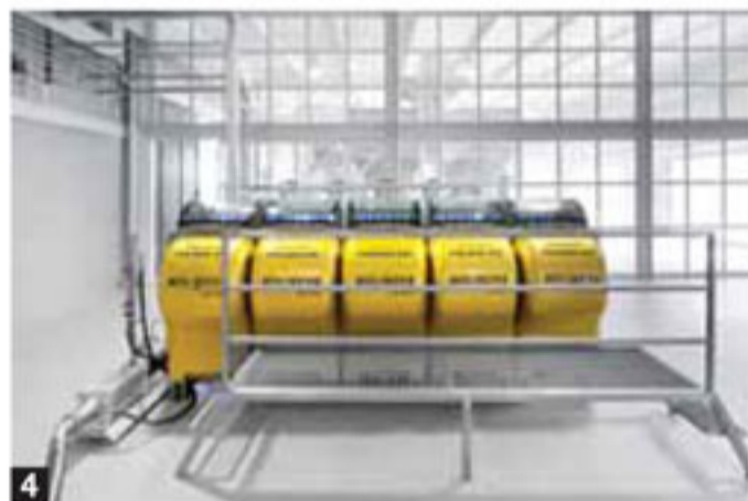
El interior de la almazara destaca por su diseño vanguardista e innovador y sus espacios amplios y luminosos. De izqda. a dcha. y de arriba a abajo, zona de recepción (1); molinos de martillos y cuchillos en la zona de molturación (2); maquinaria de Pieralisi y Mori (3); zona de batido en frío, con batidoras Pieralisi Molinova Serie Oro (4); decánter Pieralisi SPI-222 S en la zona de separación (5); centrífuga vertical Pieralisi Serie MARTE en la zona de extracción (6).
