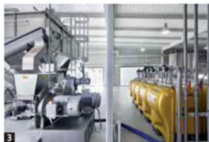
Depósitos de acero inoxidable inertizados AISI 316 (Decalinox) en la nave de almacenamiento.
