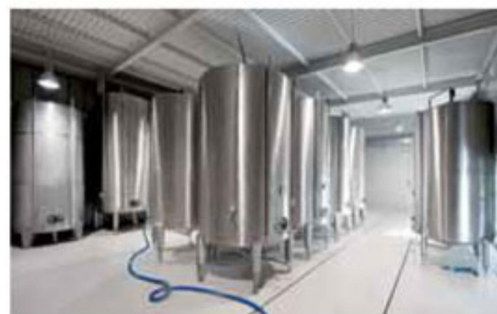
Depósitos de acero inoxidable inertizados AISI 316 (Decalinox) en la nave de almacenamiento.
