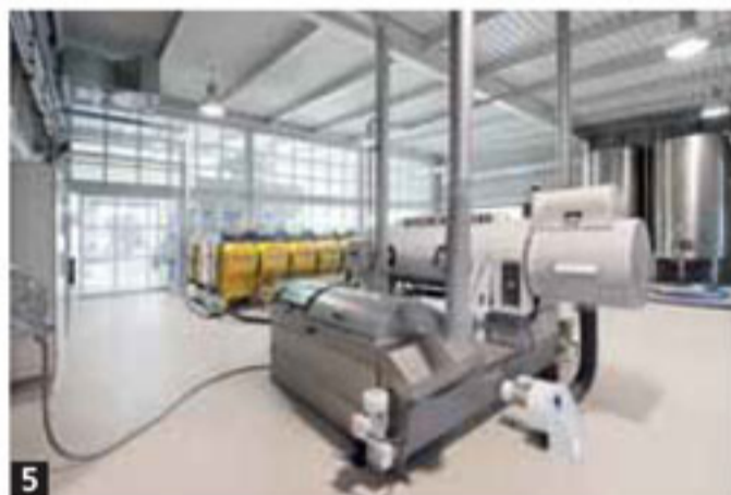
El interior de la almazara destaca por su diseño vanguardista e innovador y sus espacios amplios y luminosos. De izqda. a dcha. y de arriba a abajo, zona de recepción (1); molinos de martillos y cuchillos en la zona de molturación (2); maquinaria de Pieralisi y Mori (3); zona de batido en frío, con batidoras Pieralisi Molinova Serie Oro (4); decánter Pieralisi SPI-222 S en la zona de separación (5); centrífuga vertical Pieralisi Serie MARTE en la zona de extracción (6).
